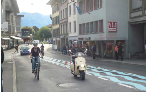
Abb. 8.2 Flächiges Queren in Thun; Die blauen Wellen dienen als Mittelzone. Das V85 im Regime „generell 50 innerorts“ liegt tagsüber bei 25km/h und der Schnitt über 24 Stunden bei 30km/h. Die durchschnittliche Durchfahrtszeit der Motorfahrzeuge und die Wartezeit der Fussgänger sind gesunken. Pro Jahr entfallen Kosten von rund Fr.200'000.- für hinfällige Verkehrsdienste.
