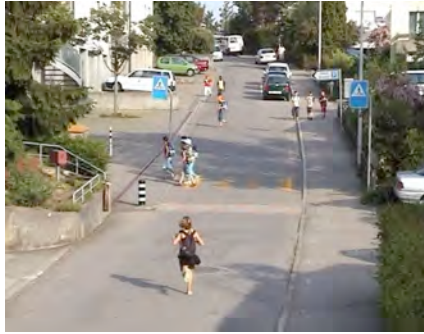
Abb. 5.12 und 5.13 Tempo-30-Zone Schlieren Köniz mit vertikalem Versatz beim Schuleingang. Der im Bild noch sichtbare Fussgängerstreifen wurde unterdessen nicht mehr erneuert, weil er unzweckmässig ist.
